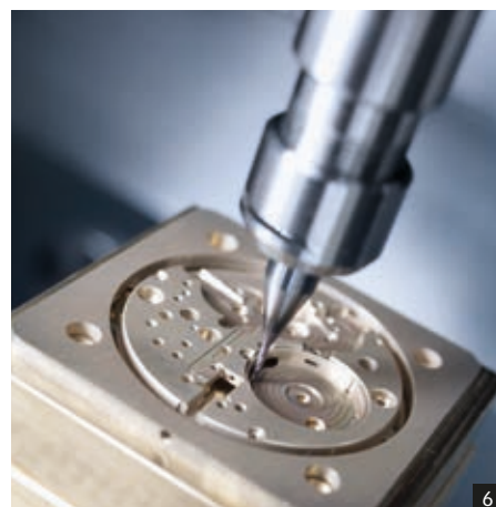
1: Zona lavoro: tavola rotobasculante CN integrata 2: Lavorazione completa a 5 assi di una piastra ossea in titanio 3: Lavorazione di finitura di un componente di femore in CrCo 4: Motori lineari in X / Y / Z con accelerazione > 2g 5: Cambio utensile da 24 posti di serie (opzione: 60 posti) 6: Quadrante di orologio
