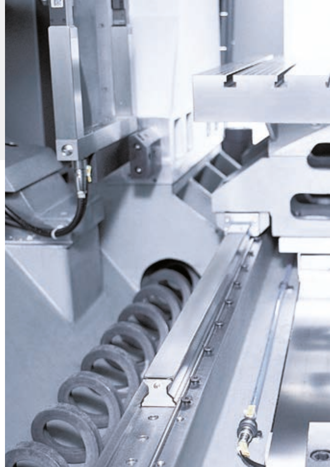
1: Lavorazione simultanea a 5 assi 2: Elettromandrino da 18.000 min -1 3: Azionamenti lineari e sistemi di misura diretti su tutti gli assi
