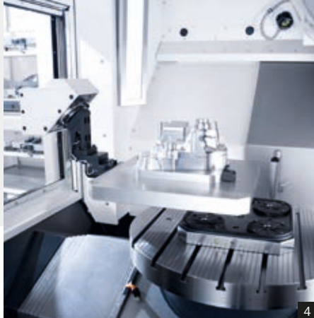
3: Magazzino pallet da 20 pezzi 4: Gestione pallet per pezzi fino a max. 200 kg
