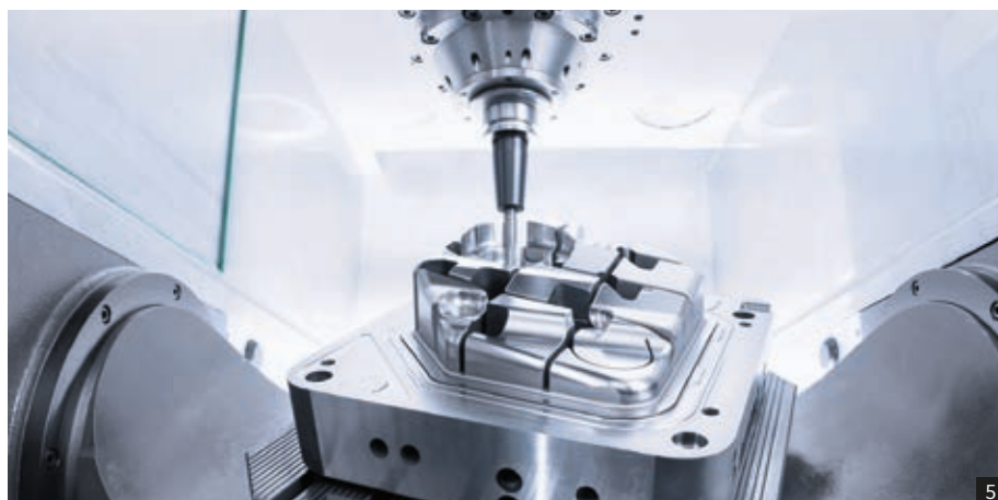
1: Struttura a portale termosimmetrica con azionamento Gantry 2: Magazzino utensili con pinza doppia 3: Lavorazione simultanea a 5 assi di uno stampo ad iniezione in acciaio temprato 4: Azionamenti lineari su X/Y/Z con > 2g 5: Lavorazione a 5 assi: tavola rotobasculante CN integrata con azionamenti torque
