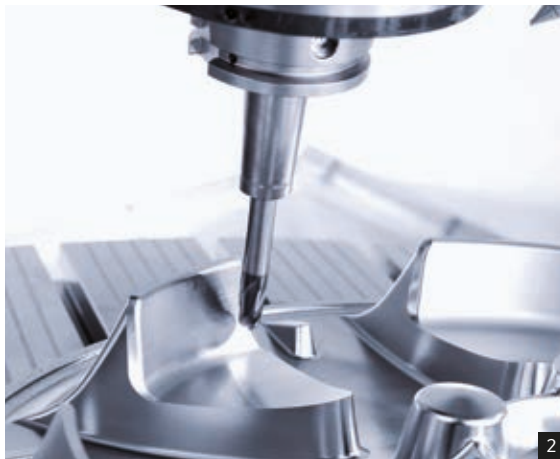
1: Lavorazione simultanea a 5 assi 2: Elettromandrino da 18.000 min -1 3: Azionamenti lineari e sistemi di misura diretti su tutti gli assi
