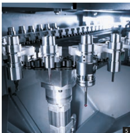
1: Zona lavoro: tavola rotobasculante CN integrata 2: Lavorazione completa a 5 assi di una piastra ossea in titanio 3: Lavorazione di finitura di un componente di femore in CrCo 4: Motori lineari in X / Y / Z con accelerazione > 2g 5: Cambio utensile da 24 posti di serie (opzione: 60 posti) 6: Quadrante di orologio
