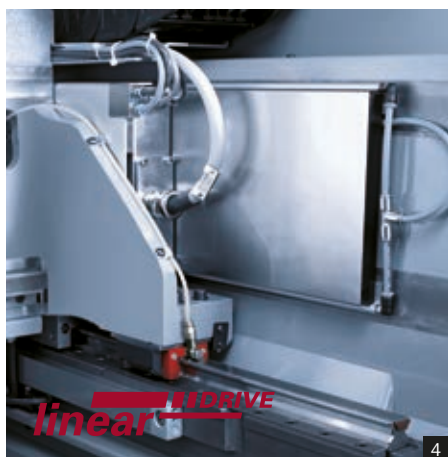
1: Zona lavoro: tavola rotobasculante CN integrata 2: Lavorazione completa a 5 assi di una piastra ossea in titanio 3: Lavorazione di finitura di un componente di femore in CrCo 4: Motori lineari in X / Y / Z con accelerazione > 2g 5: Cambio utensile da 24 posti di serie (opzione: 60 posti) 6: Quadrante di orologio
