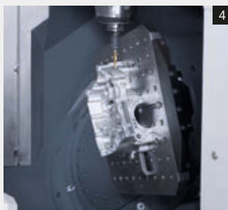
2-5: Il campo di brandeggio straordinariamente ampio della tavola rotobasculante CN è adatto a qualsiasi esigenza di lavorazione completa
