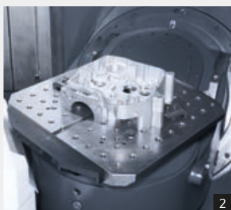
2-5: Il campo di brandeggio straordinariamente ampio della tavola rotobasculante CN è adatto a qualsiasi esigenza di lavorazione completa
